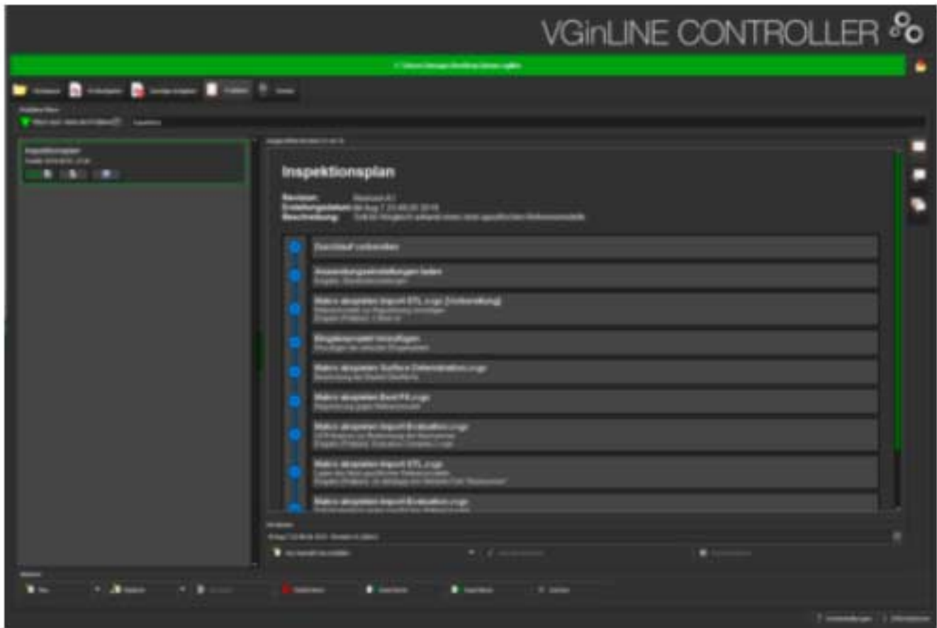
Bild 2 | Der VGinLine Controller erlaubt den Zugriff auf den Inspektionsplan eines Bauteils. Welche Analysen in welcher Reihenfolge durchzuführen sind, wird dort definiert.
