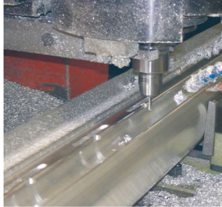
Torprofile von Erhard: Man sieht die innere Verrippung, die Nut für die Netzhaken und die geprägten Senkungen zur Verschraubung mit dem Eckverbindungsstück.
