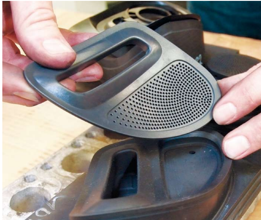
Zur Herstellung der Werkzeuge für die Lautsprecherblenden wurden auch Graphitelektroden benötigt. Wichtiges Hilfsmittel: das Modul Quick Electrode.
